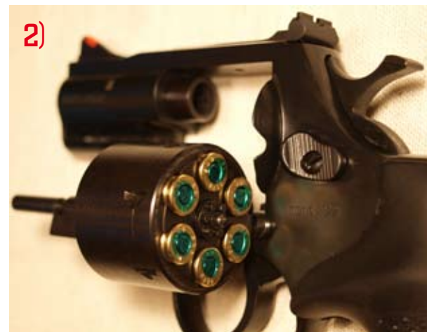
2) ■ Díky náběhům do nábojových komor probíhá vkládání nábojů velmi rychle, plynule a bez odporu.
