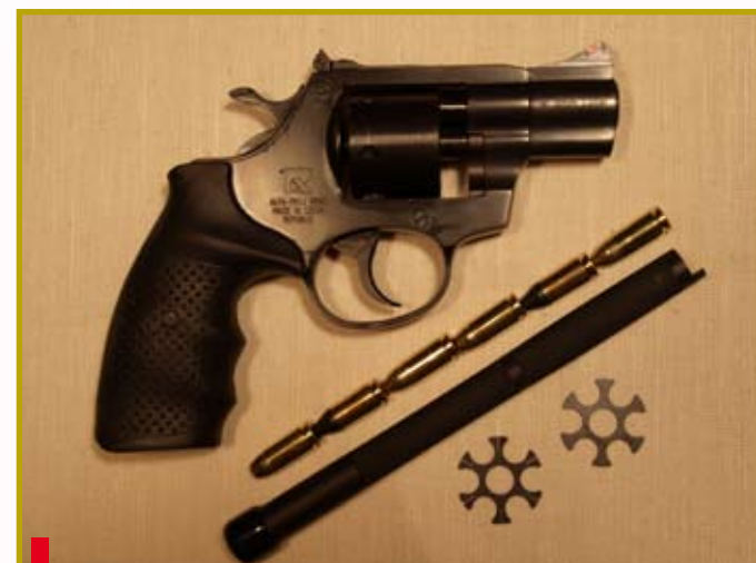
■ K pohodlnému plnění nebo vybití klipů slouží přípravek Para Loader, což je speciální ocelová trubka, do níž se naskládají náboje (jako na fotografii) a pak se jednoduchým způsobem zasazují do klipů. Vybití probíhá opačným postupem a celkovou manipulaci s Para Loaderem popisujeme na dalších snímcích.
